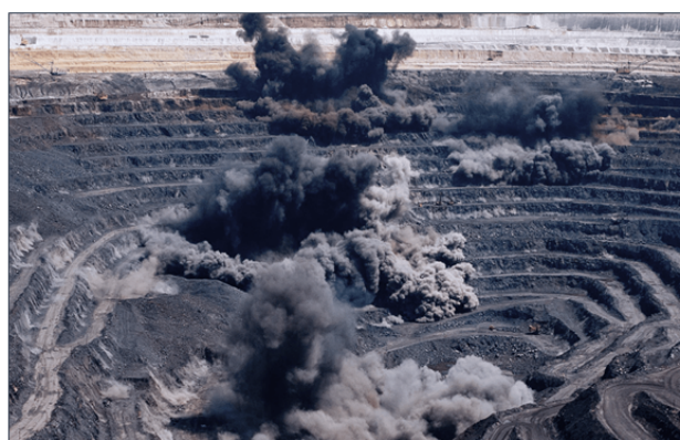
Рисунок 5 – Буровзрывные работы на карьере
