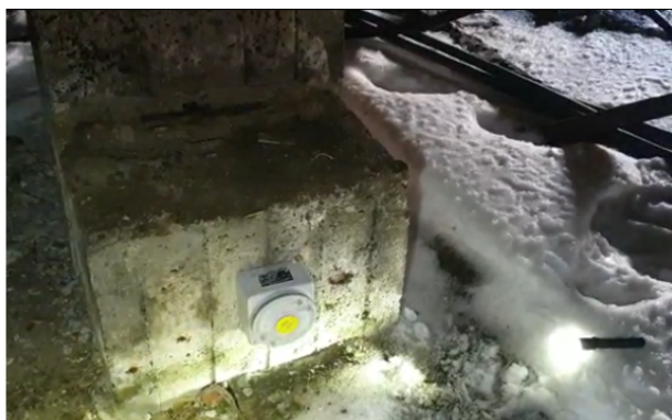
Рисунок 36 – Установка сейсмографа ZET7152N
