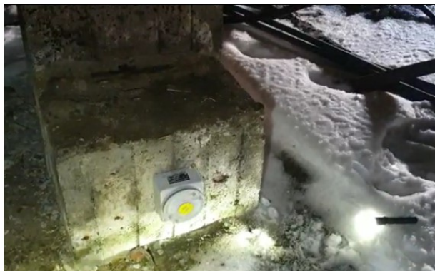
Рисунок 36 – Установка сейсмографа ZET7152N
