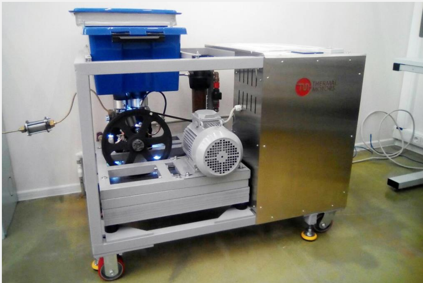
Исследовательский стенд холодильной машины для систем тригенерации. Совместная разработка специалистов ВШГиЭС ИСИ СПбПУ и ООО «Тепловые моторы» (г. Москва)
