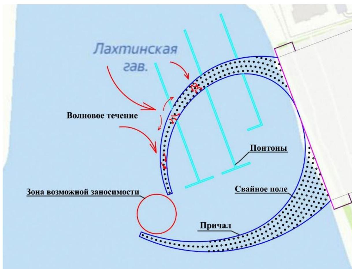
Рис. 2. Схема расположения основных элементов
