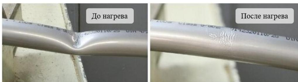
Рис. 3. Молекулярная память труб из сшитого полиэтилена
