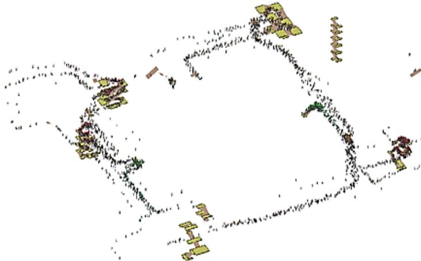
Рис. 3. Моделирование эвакуации посетителей из здания Зимнего дворца Эрмитажа. Показаны лестницы и расположение людей на 135 секунде эвакуации
