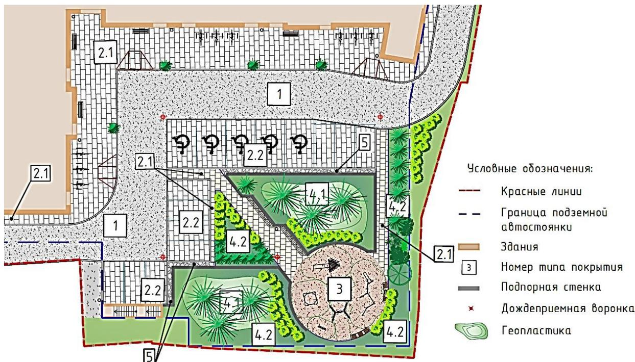
Рис. 1. План благоустройства эксплуатируемой кровли подземного паркинга
