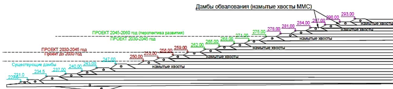
Рис. 2. Принятая расчетная модель в среде PLAXIS 2D
