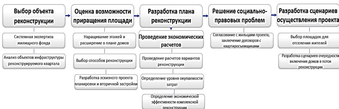
Рис. 2. Алгоритм методики производства окупаемой реконструкции
