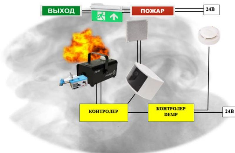
Рис. 3. Схема расположения технических средств для проведения эксперимента
