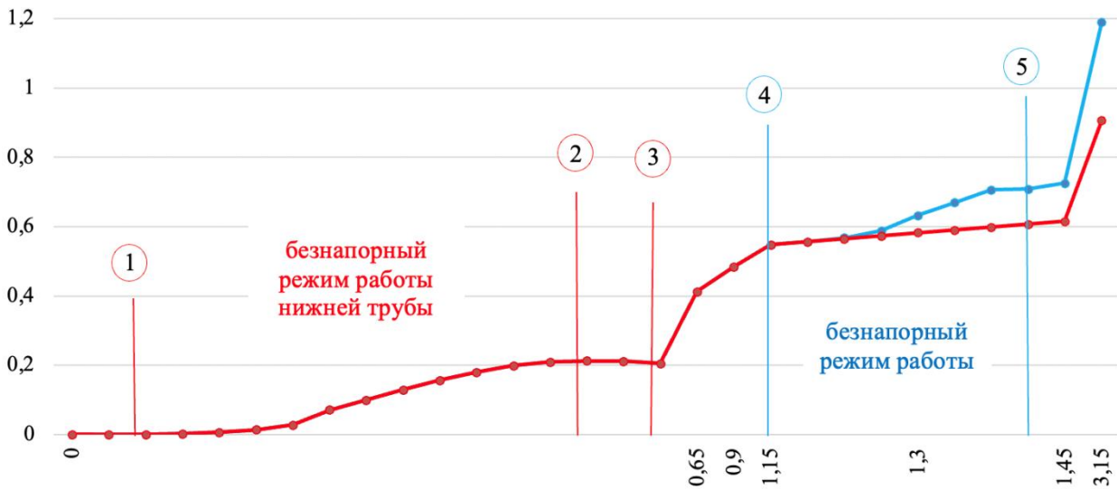
Рис. 2. График расхода жидкости при совместной работе нижнего и верхнего трубопровода: 1 – начало работы нижней трубы; 2 – максимальный расход жидкости нижней трубы при безнапорном режиме; 3 – начало работы нижней трубы в напорном режиме; 4 – начало работы верхней трубы; 5 – начало работы верхней трубы в напорном режиме
