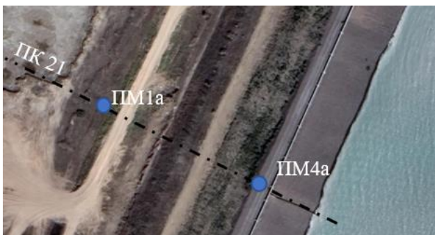
Рис. 1. Места установки поверхностных марок
