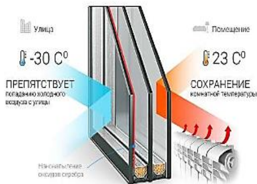
Рис. 3. Принцип работы I-стекла
