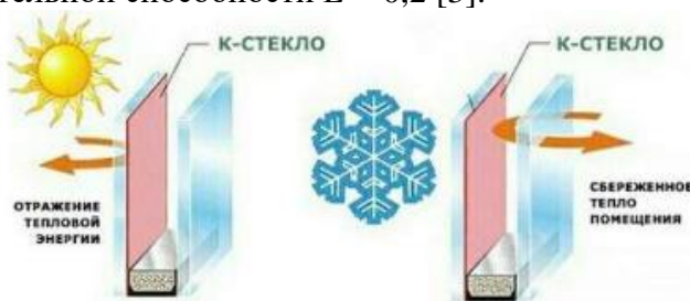
Рис. 2. Принцип работы К-стекла
