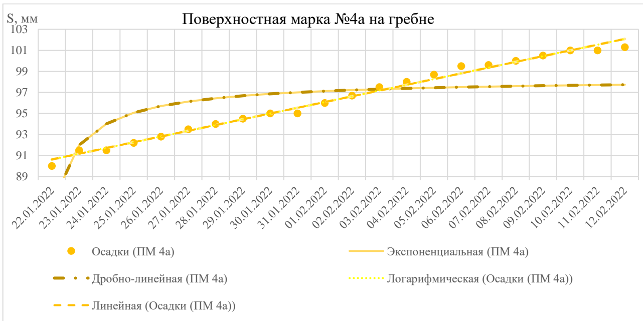
Рис. 2. Аппроксимация опытных значений осадки гребня дамбы золоотвала ТЭЦ
