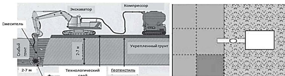
Рис. 2. Метод блочной стабилизации грунта
