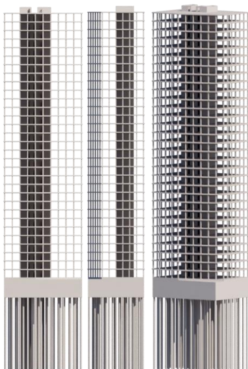
Рис. 6. Ствольно-оболочковая конструктивная система
