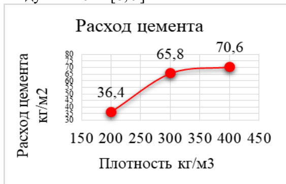
Рис. 1. Влияние плотности пенобетона на расход цемента
