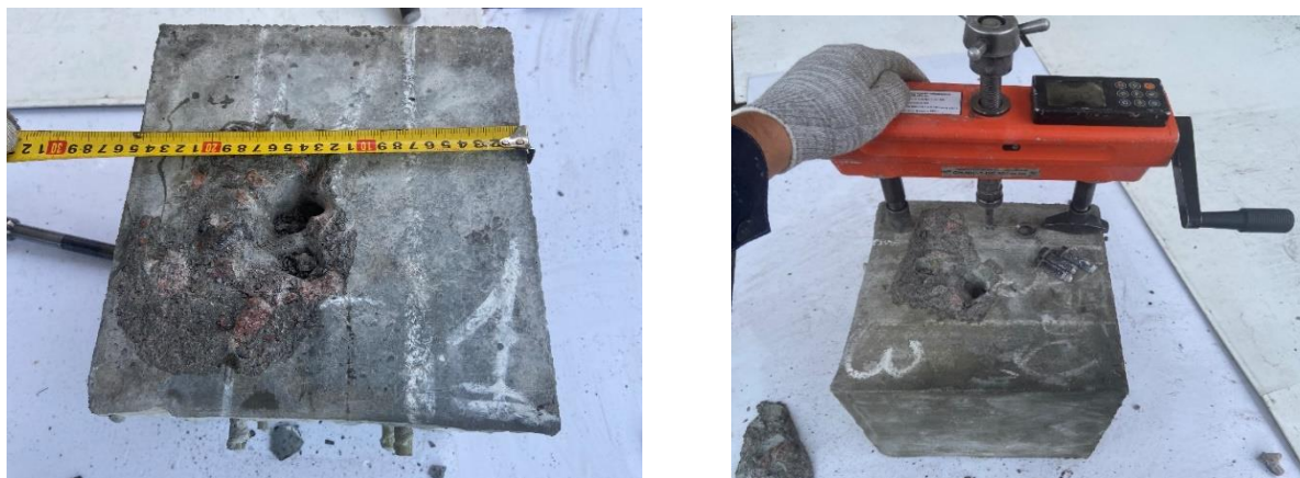
Рис. 2. Готовые образцы-куб бетона с армированием композитной арматурой с защитным слоем бетона 50 мм после проведения испытания
