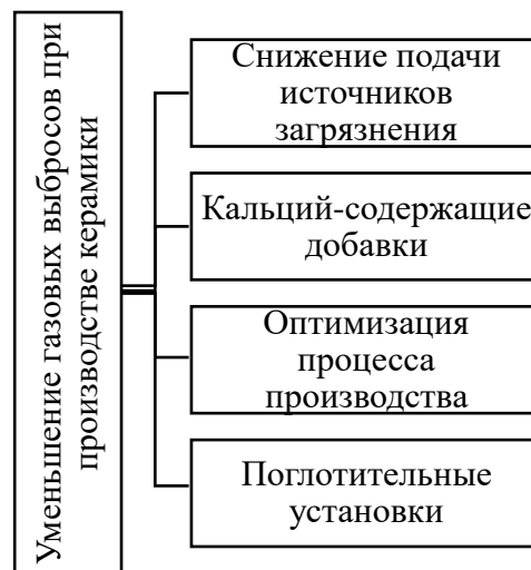
Рис. 1. Возможные решения проблемы газовых выбросов при производстве керамики
