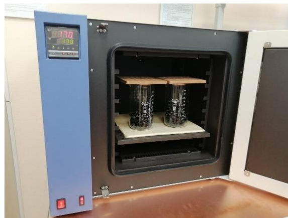
Рис. 2. Стаканы со смесью в сушильном шкафу при температуре 170°C
