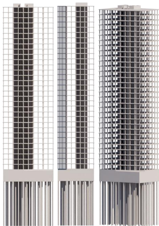
Рис. 3. Каркасно-ствольная конструктивная система
