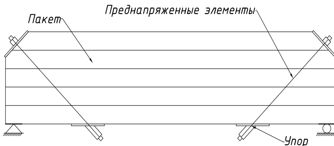
Рис. 1. Схема клееной древесной балки, усиленной затяжкой из стеклопластиковой арматуры
