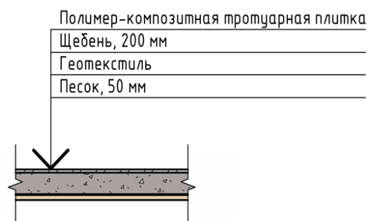
Рис. 2. Схема укладки полимер-композитной тротуарной плитки
