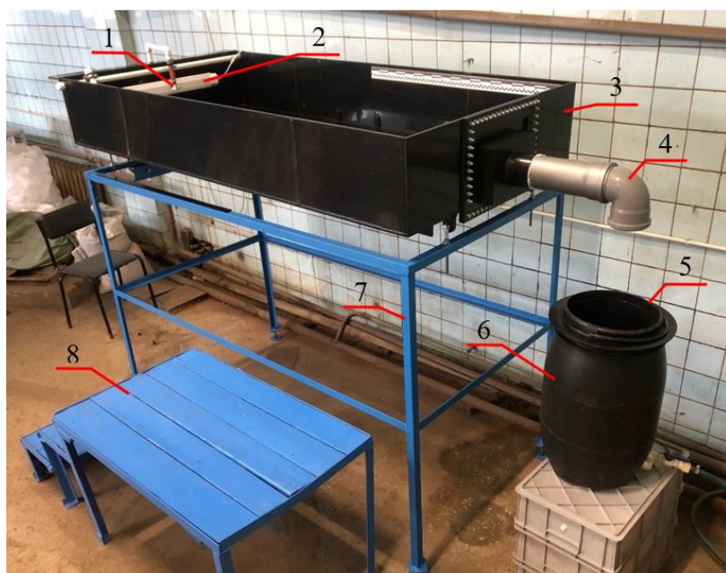
Рис. 1. Лабораторно-испытательный стенд для измерения и моделирования процессов смыва взвешенных веществ и мусора осадками:
