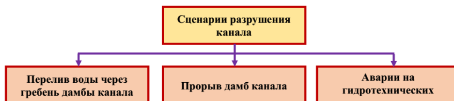
Рис. 3. Возможный сценарий, приводящий к аварии канала
