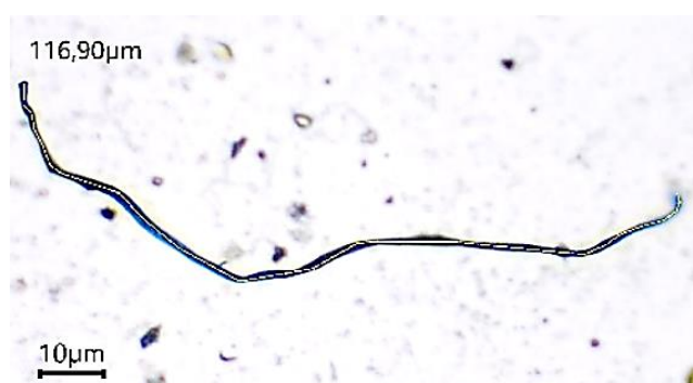
Рис. 1. Обнаруженная частица МП в водопроводной воде размером 116,9 мкм
