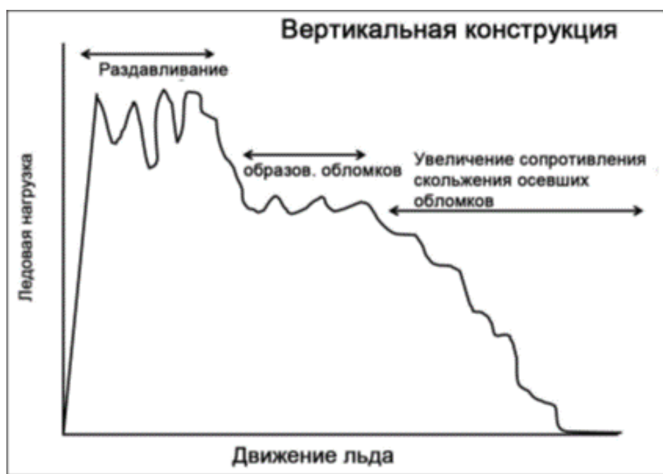
Рис. 1. Стандартная зависимость ледовой нагрузки от движения льда при воздействии льда на широкую вертикальную конструкцию на мелководье [2]
