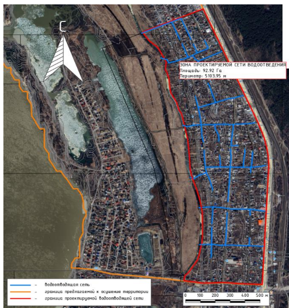
Рис. 2. Трассировка самотечной ливневой канализации в зоне проектирования
