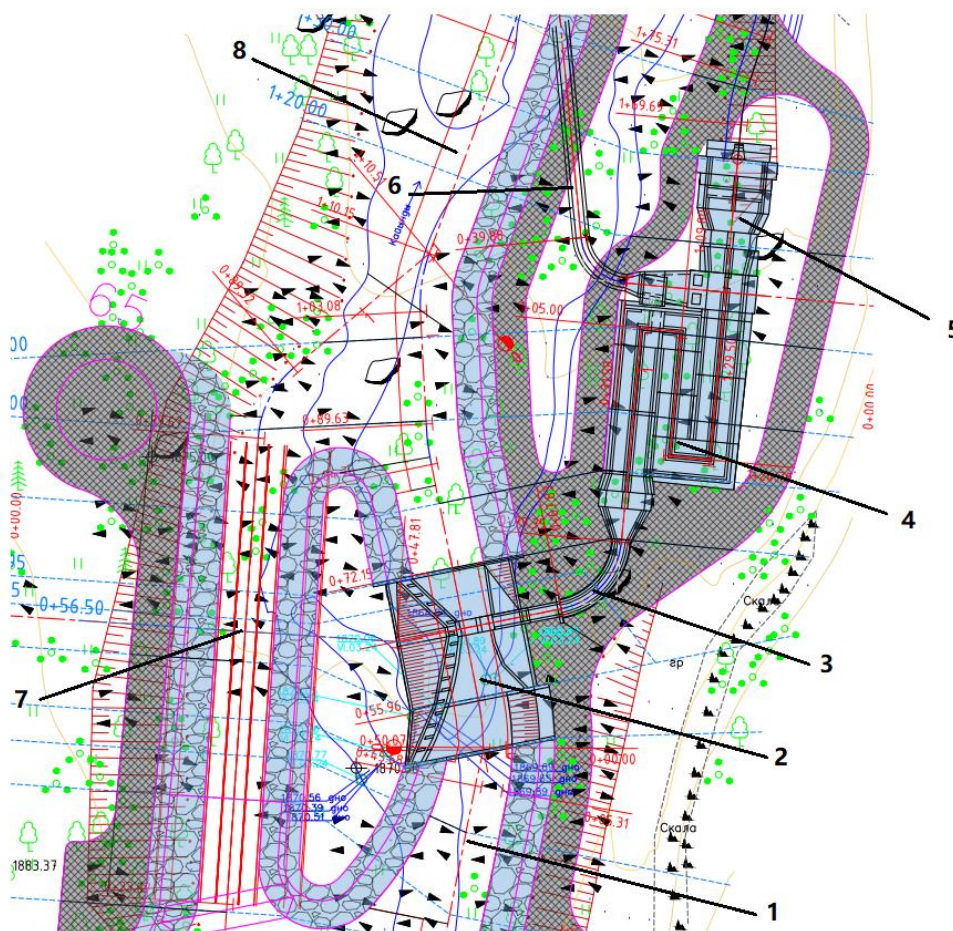
Рис. 1. Предлагаемая схема размещения сооружений водозаборного гидроузла
