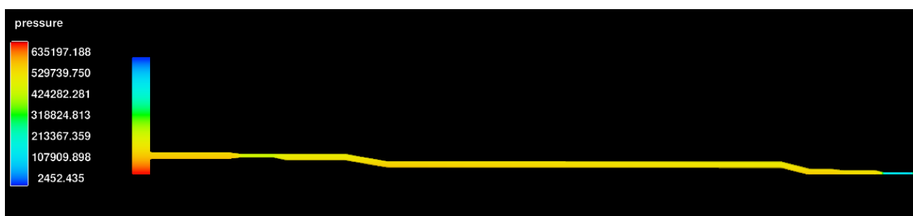
Рис. 3. Распределение гидродинамического осредненного давления. Цветом показана шкала давления
