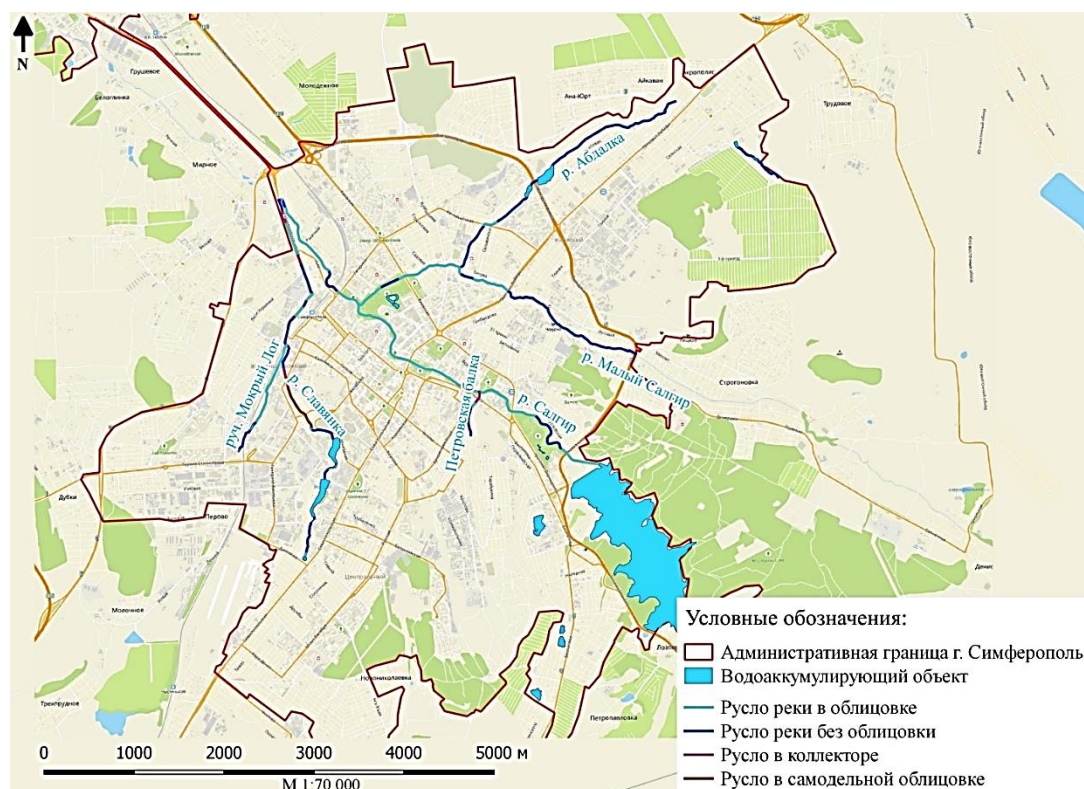
Рис. 1. Схема расположения облицованных участков русел водотоков бассейна р. Салгир на территории г. Симферополя
