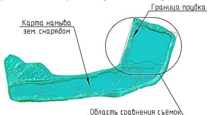
Рис. 2. Схема карты намыва земснарядом с отображением поверхности, построенной по геодезической съёмке
