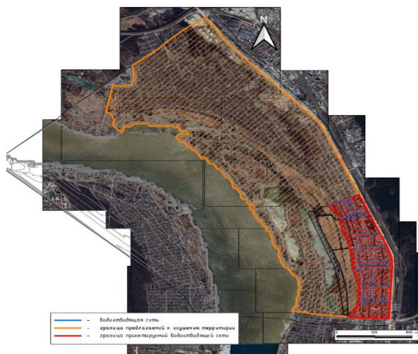
Рис. 1. План территории (в Civil 3D), предполагаемый к осушению, с демонстрацией участка расположения самотёчной
