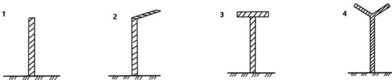
Рис.1. Формы шумозащитных экранов в поперечном разрезе: 1 – плоский экран, 2 – Г-образный профиль, 3 – Т-образный профиль, 4 – Y-образный профиль
