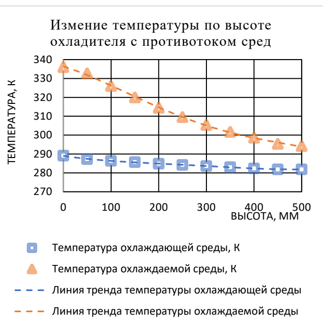
Рис. 4. Изменение температуры по высоте охладителя при противотоке сред
