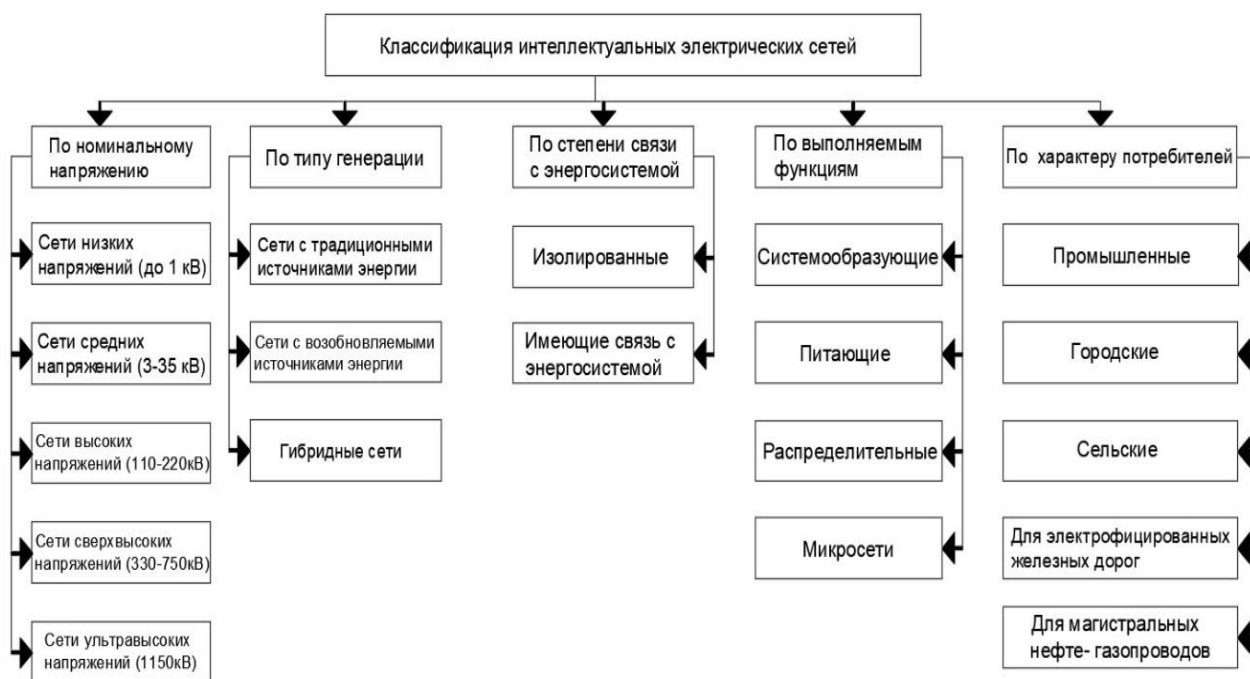
Рис. 1. Классификация интеллектуальных электрических сетей
