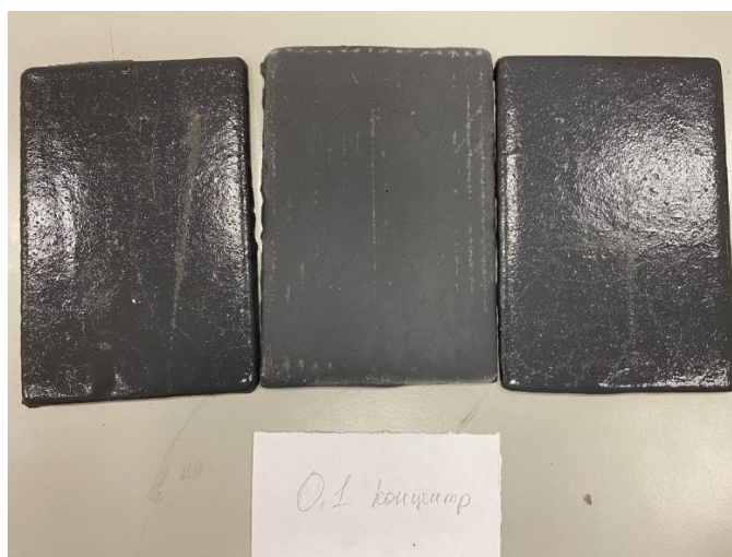
Рис. 1. Пластины с астраленами в концентрации 0,1 после обработки в жидком азоте
