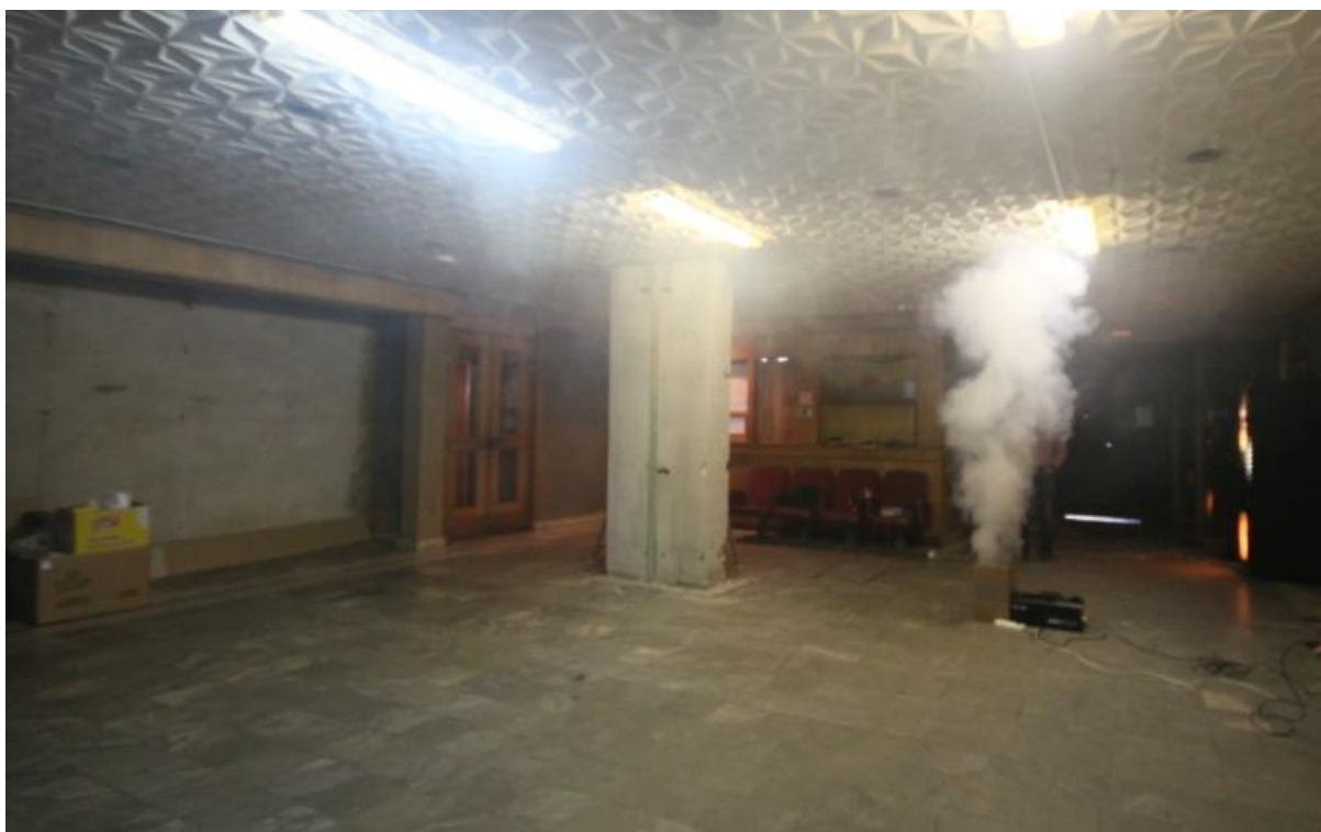
Рис. 1. Испытания АПС на объекте с помощью дымогенератора «КИПАРИС-П (Ст)»
